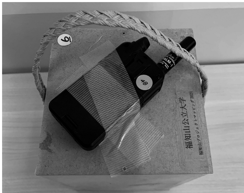
図 4 デジタル小電力コミュニティ無線の固定
