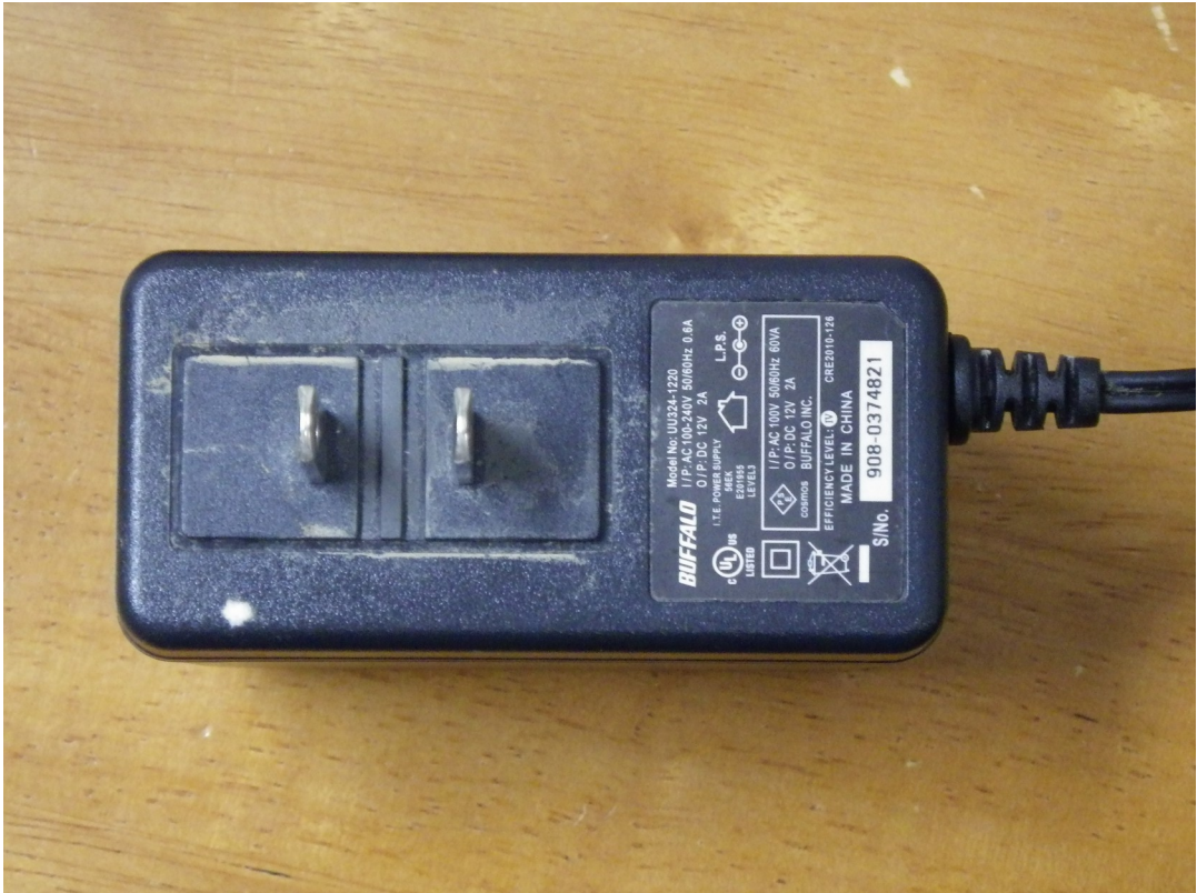
図9 水没し泥の付着した外付けハードディスク装置用 AC アダプタ
