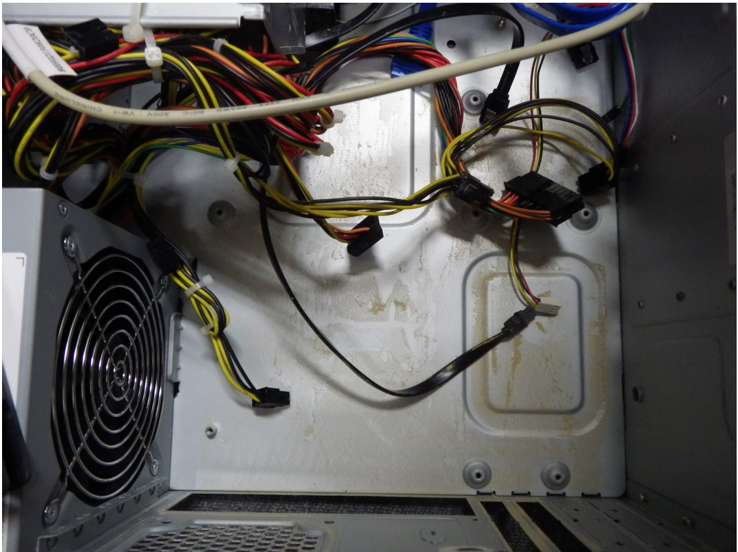
図3 筐体内への泥の侵入
