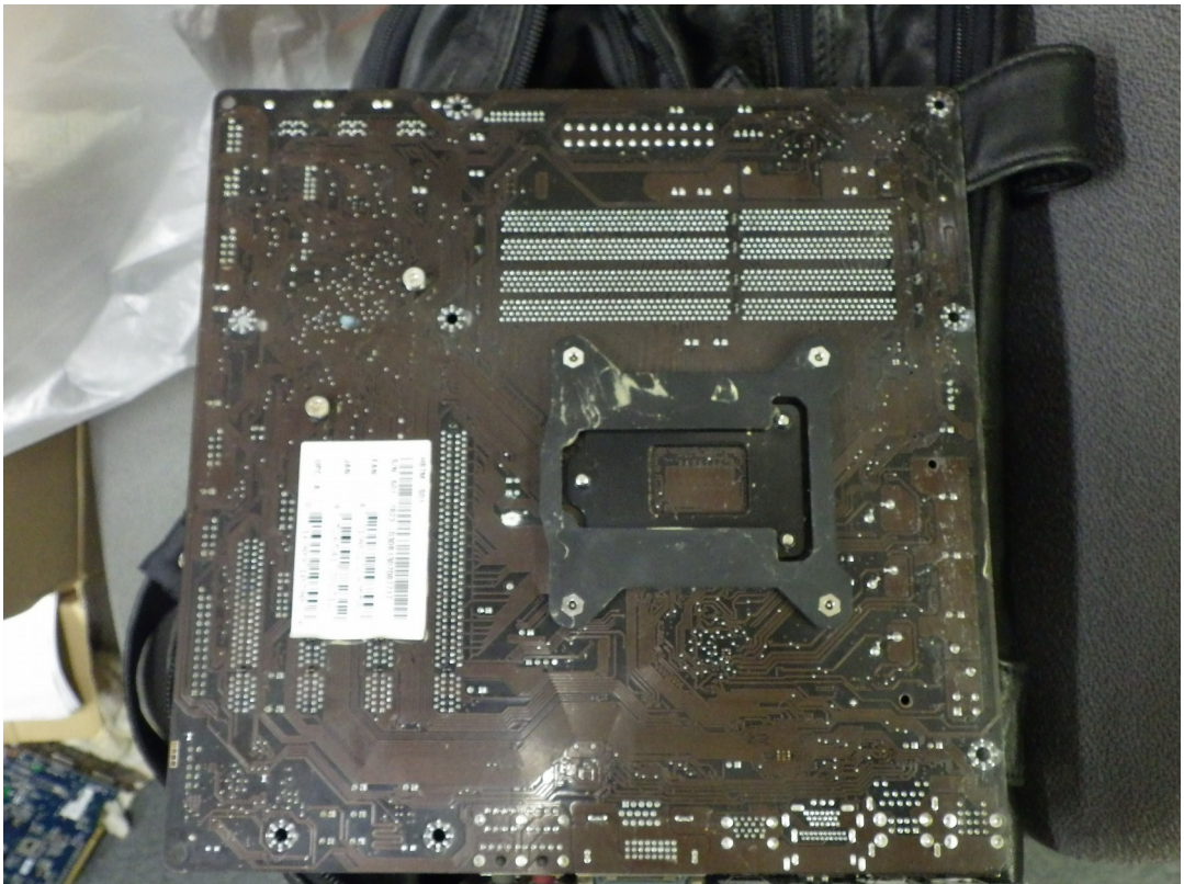
図4 マザーボードへの泥の付着
